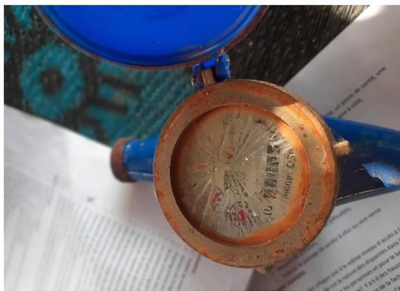
*Figure 7. – Compteur volumétrique d'eau explosé.
